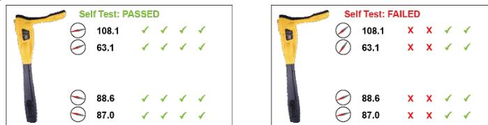
Si el test es negativo vuelva a repetirlo en una zona libre de interferencias. Si el test sigue siendo negativo retorne el equipo a Vivax-Metrotech o a su distribuidor autorizado.
