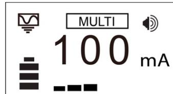
6. Las frecuencias seleccionadas en modo multi-frecuencia permanecerán activas hasta que se desactive el modo multi-frecuencia.
