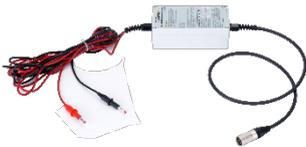
Para utilizar con cables “vivos” de hasta 480 VAC y 60/50Hz. Opera con las frecuencias de 8,192 KHz, 32,768 KHz y 8,44 KHz SIS. Para tener mejores resultados conectar a una fase del cable y una tierra independiente.
