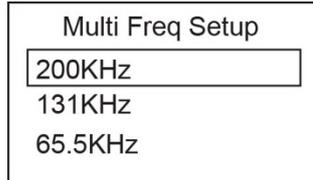
3. Pulse "f" para desplazar el recuadro hacia abajo y las teclas " $\triangleleft$ " y " $\triangleup$ " para seleccionar la segunda frecuencia.
