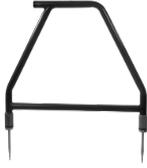
El accesorio A-frame sirve para detectar defectos a tierra en cables y tuberías. En el caso de tuberías el defecto a tierra consiste en fallos en el revestimiento. En el caso de cables los fallos son causados habitualmente por daños en el aislamiento que hacen que el conductor o su pantalla metálica de protección estén en contacto con el terreno.
