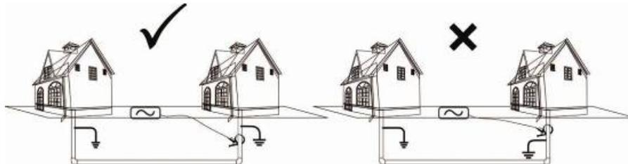
4. Si no fuera posible emplear la pinza de inducción y tiene confirmación de que el cable está fuera de servicio puede hacer una conexión directa al cable. Si aísla el cable de otros evitará que la señal viaje también por otros cables acoplados físicamente.
